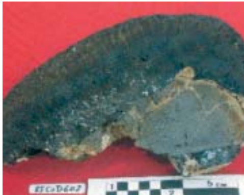
Разрез железомарганцевой корки (КоРМС-Х. Ауки)
